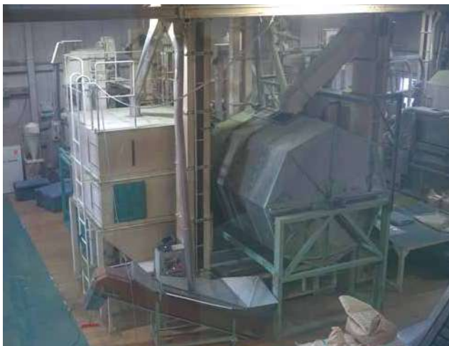
3,000kgの茶葉を製茶できる製造ライン
