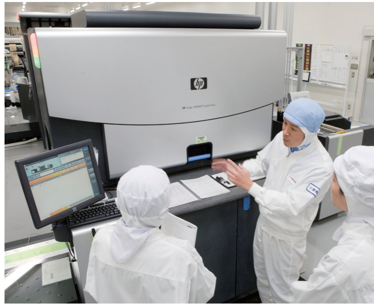
「エスプリ」の見目は、大きなサイズのプリンタといった感じ。PCから送られたデザインデータを受信し、フィルムに印刷される。グラビア印刷は、色の調合など印刷を始めるまでに時間がかかり、印刷自体の時間は短い。一方で「エスプリ」は事前の準備には時間がかからないが、実印刷の工程が従来のグラビアよりも時間を要する。
