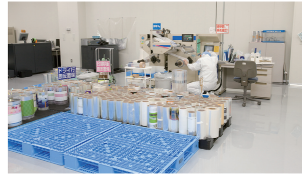
食品メーカーのパッケージ印刷を手掛けるケースが多いことから、2013年6月より「エスプリ」工場はクリーンルーム化を実現。異物混入を防ぐため、ボールペンはキャップのついていないもの、カッターも刃の折れないものなど、工場内に持ち込める私物にも厳密な制限がある。
